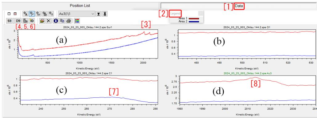
図 7.3 測定されたオージェ電子スペクトル。(a) サーベイススペクトル, (b) 酸素オージェ電子スペクトル, (c) 炭素オージェ電子スペクトル, (d) 金オージェ電子スペクトル
