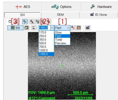
図 2.4 SXI(Scanning X-ray Imaging) の開始
