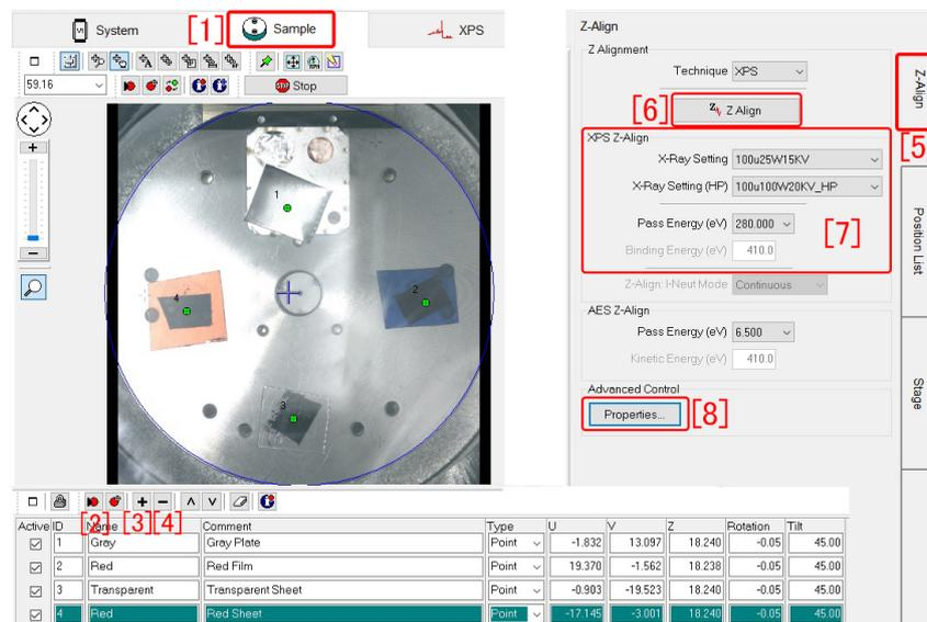
図 3.3 4カ所の測定点が登録されている
