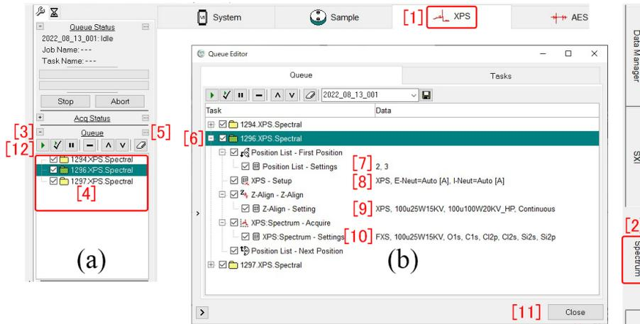
図 4.14 キューの確認とスタート。2 番目と 3 番目のポジションに対する測定条件を表示している
