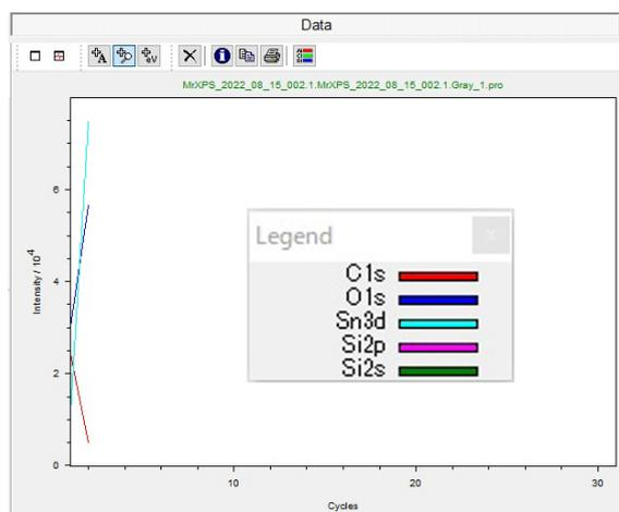
図 5.5 各ピークの積分強度の変化
