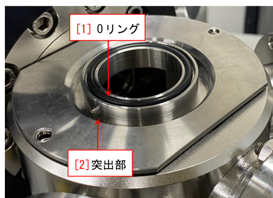
図 C.6 トランスファーベッセル用準備室上部治具にとりかえたところ
