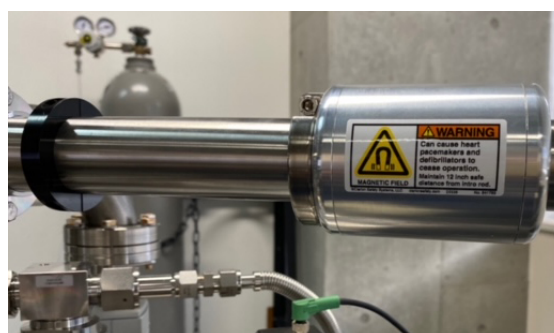
図 2.2 V1 バルブが開いたら、サンプル導入グリップがストッパーで止まるところまで、差し込む
