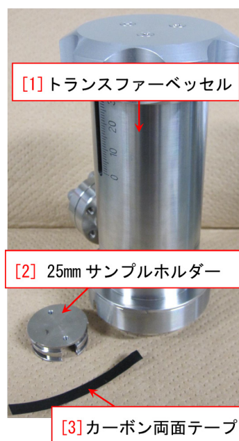
図 C.1 トランスファーベッセル, 25mm サンプルホルダー, 両面テープ
