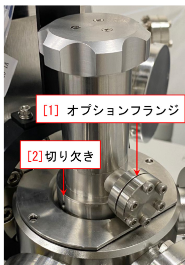
図 C.7 トランスファーベッセルを取り付けたところ。大気圧で押さえることになるのでネジ止めは必要ない。180°回転しても問題ない
