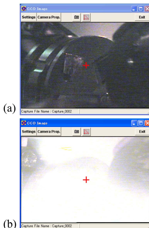
図 A.5 マグネシウムないしはジルコニウム線源が ON になると (a) 暗かったメインチェンバーの中が (b) フィラメントの光で明るくなる
