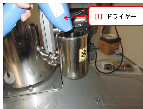
図 E.10 ドライヤーで液体チツ素タンク内をブローします
