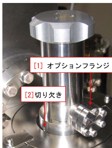
図 B.7 トランスファーベッセルを取り付けたところ
