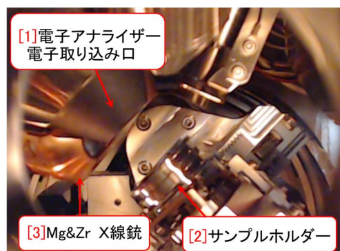
図 F.8 Mg&Zr X線源をスライドインさせたところ
