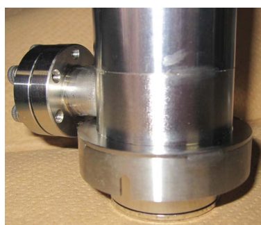
図 B.3 トランスファーベッセル底部を閉じたところ
