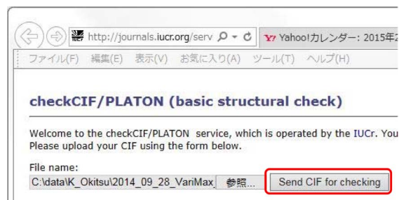
図 2.54 Send Cif ボタンのクリックにより、Cif.Cif が IUCr に送付し、解析結果をチェックできます
